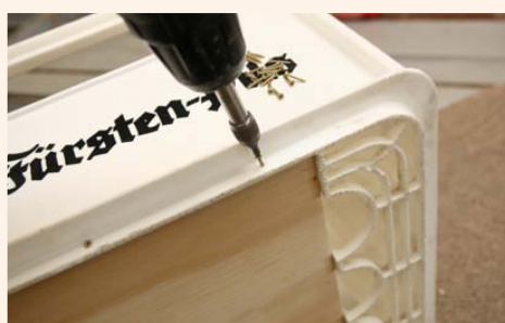
▲ Der eingefälzte Boden wird verschraubt
