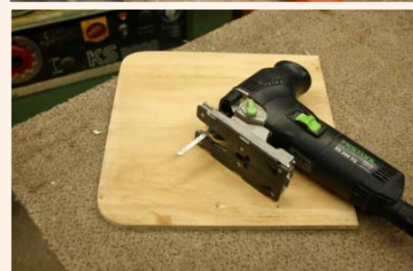
Die Ecken werden mit der Stichsäge abgerundet
