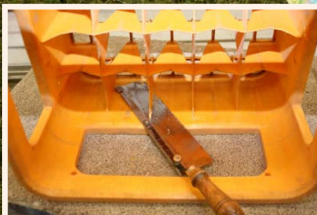
Die Ausfachung wird mit der Feinsäge herausgeschnitten
