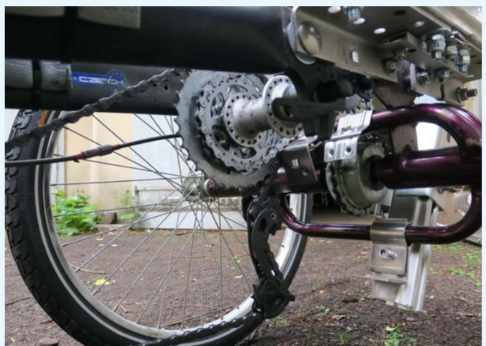
▲ Die drei Ketten, rechts die von den Pedalen her kommende antreibende, in der Mitte das Zwischengetriebe und links die Kette zum Differential für die Hinterrad-Achse.
