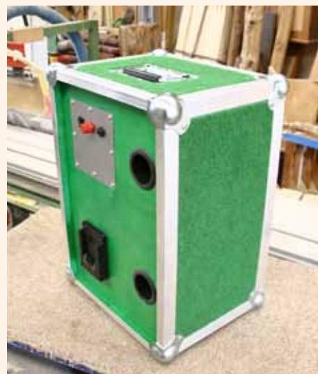
◀ Der fertige Brüllwürfel von hinten mit Akkuhalter-Bassreflexrohren und Bedienfeld
