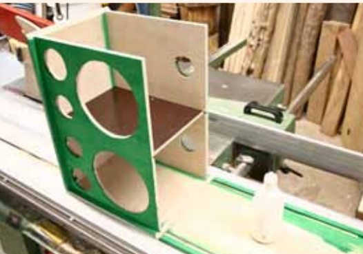
◀ Die Stereo-Box wurde auf Gehrung mit Klebeband verleimt
