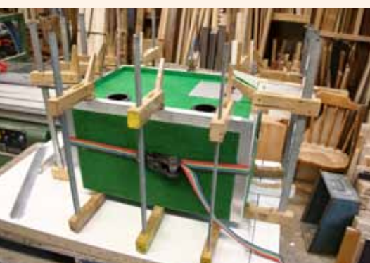
◀ Alle Kanten werden mit Eckprofilen geschützt
