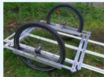
▲ Mit Aluminium- und Edelstahl-Teilen ersetzte ich die Holzpalette
