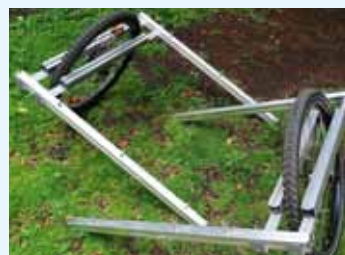
▲ Hier sieht man, dass mit dieser Art Gestell verschiedene Anhängerbreiten gebaut oder schnell eingestellt werden können
